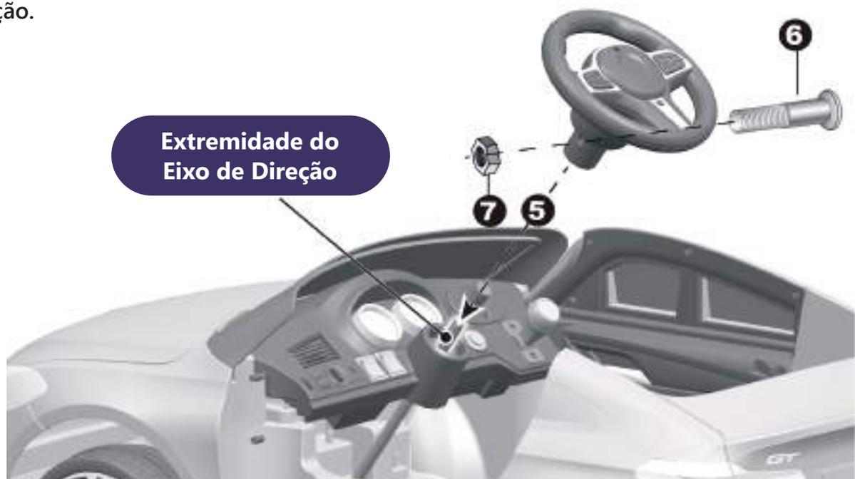
Extremidade do Eixo de Direção
