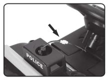
5. Conecte o cabo de energia no volante
