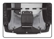
4. Instale o apoio traseiro, e prenda com 5 parafusos
