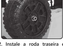
2. Instale a roda traseira e parafuse na junta
