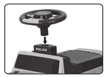
6. Conecte o cabo, instale o volante e coloque o parafuso
